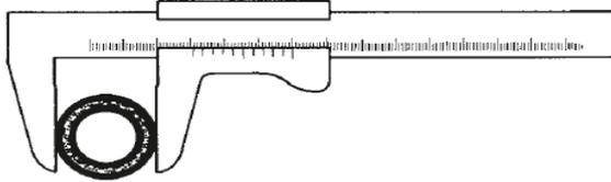
Als Voraussetzung für eine betriebssichere Montage muss der äußere Durchmesser des Schlauches dem umseitigen "OD" - Maß entsprechen. Maximale Toleranz  $\pm 0,5$  mm
